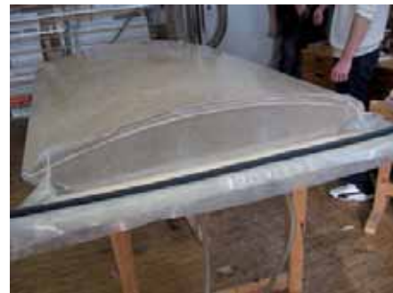
Formverleimung mit der Vakuumtechnik
