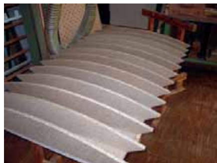
Spantengerüst für die Formverleimung Herstellung der Spanten erfolgte auf dem CNC-Bearbeitungszentrum
