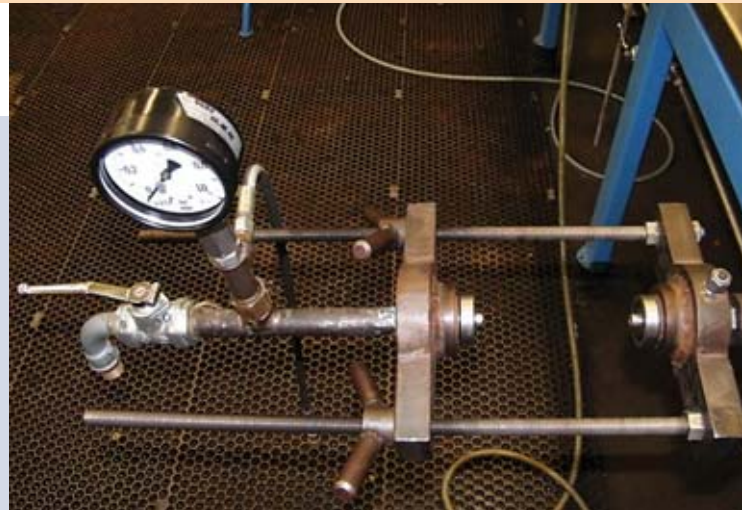
Verbund zwischen Prüfstand und Armatur
