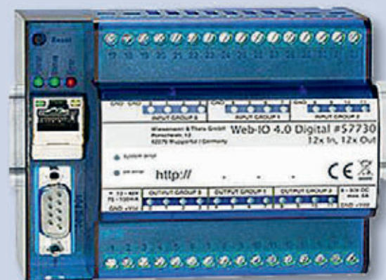
Web-1/0-Knoten (Gabler Maschinenbau GmbH)
