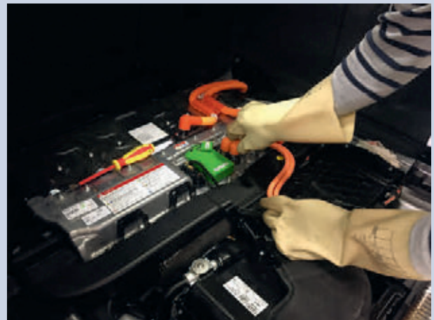
Feststellen der Spannungsfreiheit
