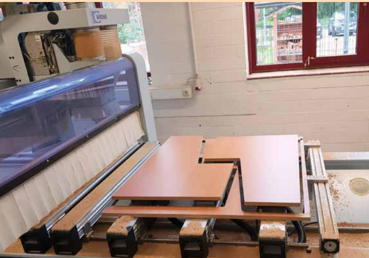
Teile für die Sitzgruppe „Atrium“ werden mit der CNC-Maschine gefertigt
