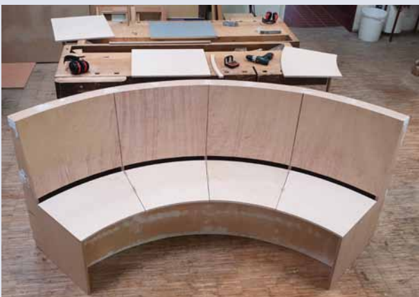
„Rohbau“ der ersten Sitzgruppe für das Atrium
