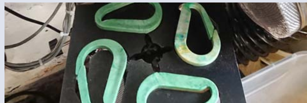
Neue Kunststoffkarabiner aus der Spritzgussmaschine
